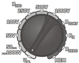
Otačecí přepínač výběru funkce nastavte v pozicii **U<sub>~</sub>**.
