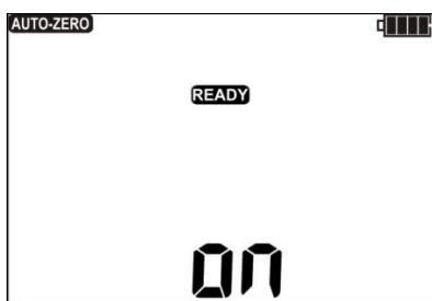
Na displeji se objeví nápis **AUTO-ZERO** a  $\Omega\Omega$ , který potvrzuje provedení kompenzace odporu měřících vodičů.
