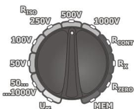
Otočný přepínač výběru funkce nastavte v pozici **R<sub>ISO</sub>** a vyberte napětí měření (v pozici **50...1000V** vybrán rozsah co 10V). Měřič se nachází v režimu měření napětí.
