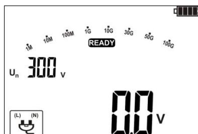
Po vložení WS-04 do zdířky se na displeji objeví zpráva o připojení adaptéra k měřiči.
